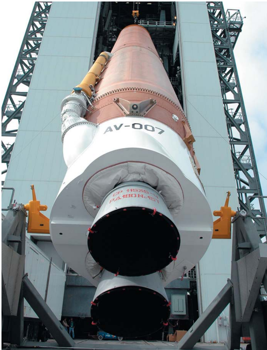
... а двигатели-то все же наши! Первая ступень ракеты-носителя «Атлас V», которая вывела в космос аппарат MRO, укомплектована российскими ЖРД типа РД-180
